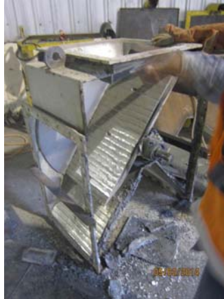
Gambar 5. Duraplate masih terlihat bagus selama operasi alat 4 tahun
