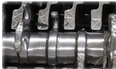
Gambar 3. Kondisi shredder sebelum pergantian total
