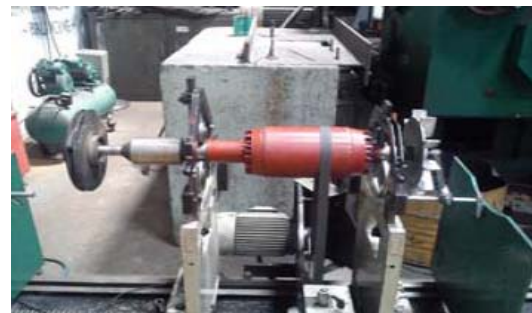
Gambar 5. Rotor sesudah naik ke mesin balancing
