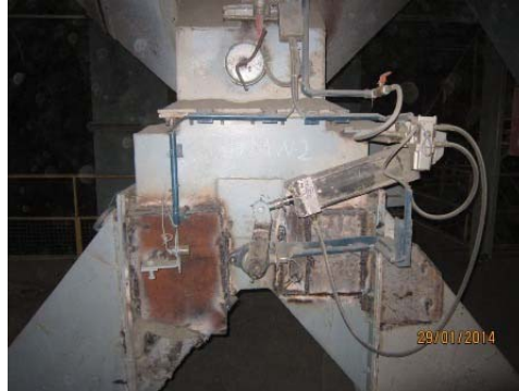
Gambar 2. Kondisi chasing yang mengalami keausan
