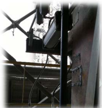
Gambar 7. Pneumatik piston drive pada sistem Material-Way 532-MW1
