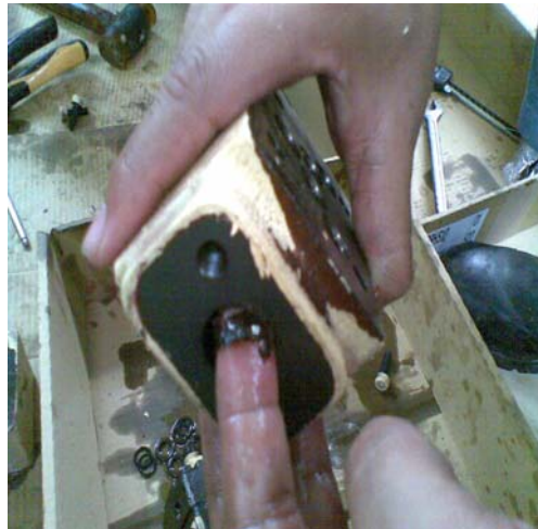
Gambar 5. Kerak pada housing
