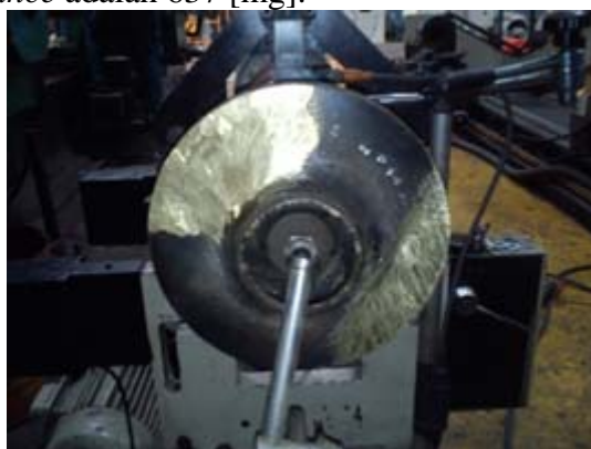
Gambar 11. Hasil pengerjaan pada plane 1 yang sudah masuk batas toleransi
