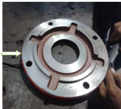
Gambar 6. cover bearing pada sisi tekan (panah putih) ke outer ditambah 0,5 mm
