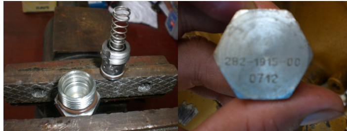
Gambar 5. Pressure regulating valve part number 282-1915(kiri), bagian dalam 282-1915 (kanan)
