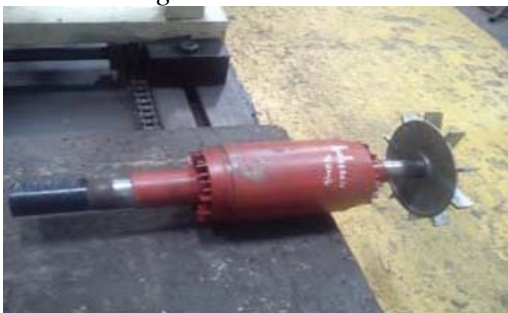
Gambar 4. Rotor sebelum naik ke mesin balancing
