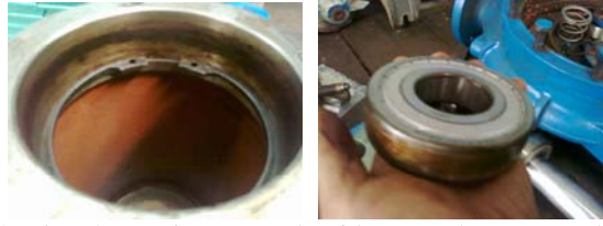
Gambar 4. Bearing mengalami keausan karena gesekan
