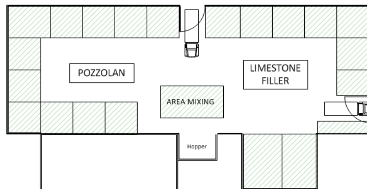
Gambar 2. Perancangan layout gudang yang diinginkan untuk menerapkan sistem FIFO
