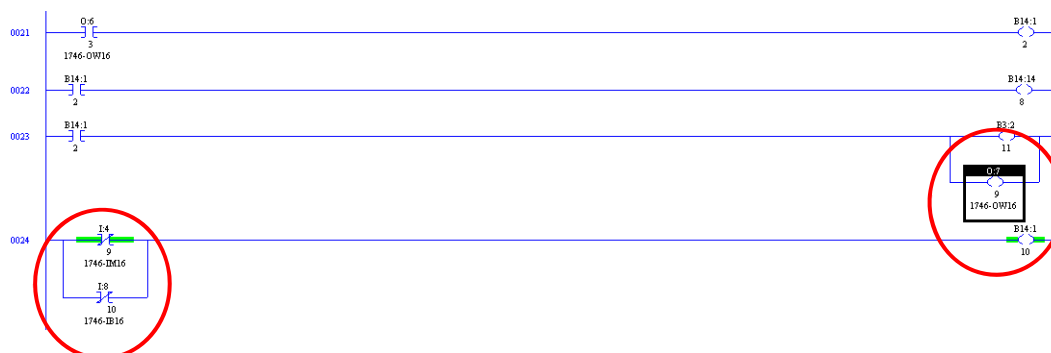
Gambar 8. Ladder Diagram Indikasi Unit ON dan Instruksi Emergency Stop (sesudah dirubah)
